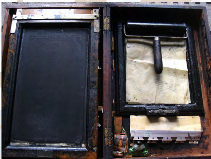
Rozmnožovací přístroj hektograf. (Zdroj: Creativecommons)
